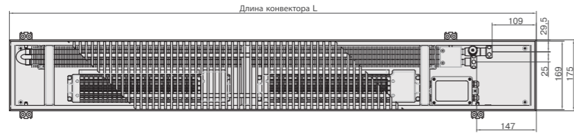
Вид сверху конвектора Qtherm ECO 175 с роликовой решеткой, с U-образным бортом.
