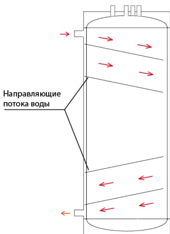
2.1. Бойлер сконструирован по схеме внутренний бак бойлера (контур горячего водяного снабжения (далее ГВС) с водяной рубашкой (контур обогрева бойлера через систему отопления (далее СО). Для повышения производительности и прочности внутри водяной рубашки предусмотрены направляющие потока воды, которые одновременно выполняют роль ребер жесткости внутреннего бака.
