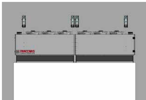
Монтаж последовательный Side by side installation
