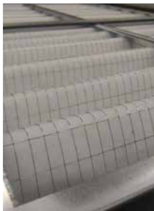
Обслуживаемый воздушный фильтр Serviceable intake air filter
